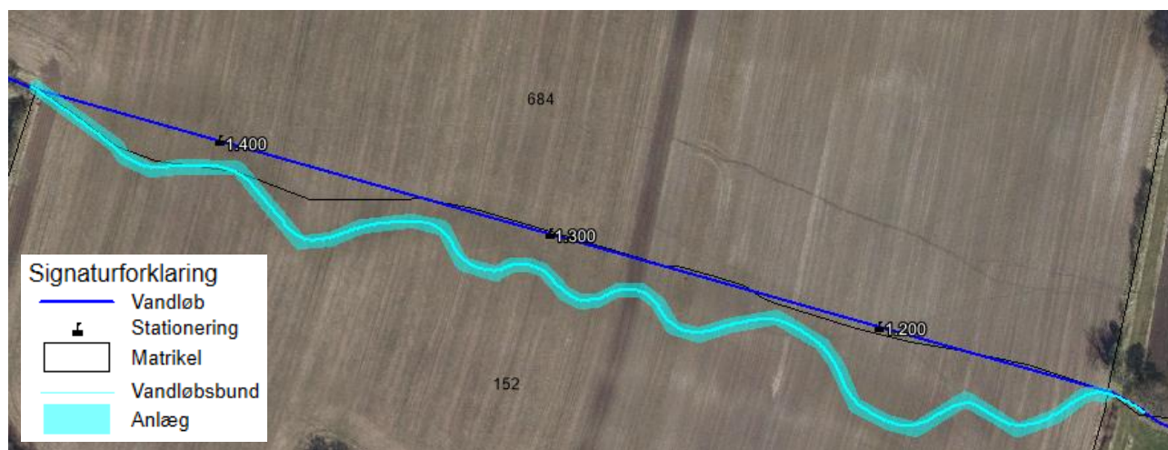
Figur 34: Estimat af det optagede areal ved en genåbning af den rørslagte strækning som projekteret.
